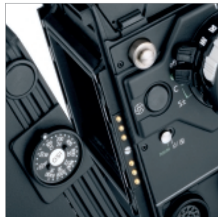
Goldkontakte für sichere Signalübertragung/ Kommunikation
